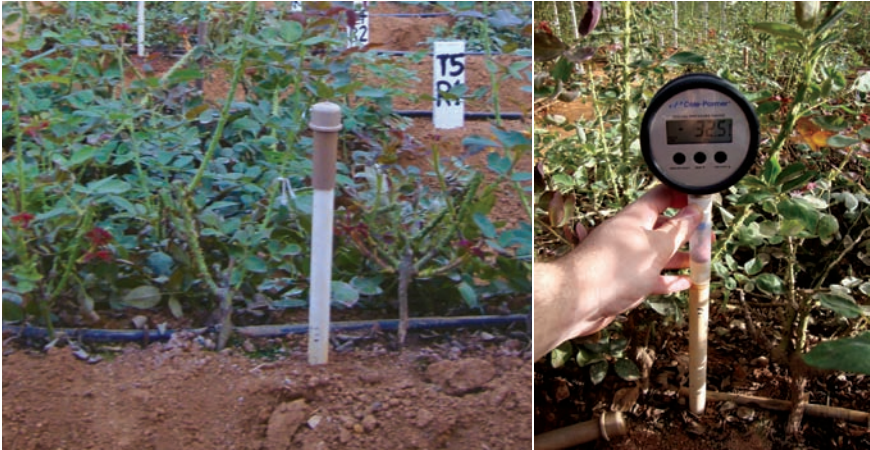
Figura 13 - Tensiômetro instalado no solo e realização das leituras de tensão por meio do tensímetro em canteiros de roseiras
