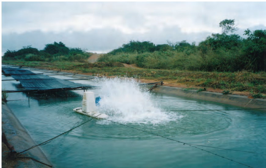
Figura 3 - Aeradores de pás podem ser utilizados para incorporar oxigênio e promover a movimentação da água
