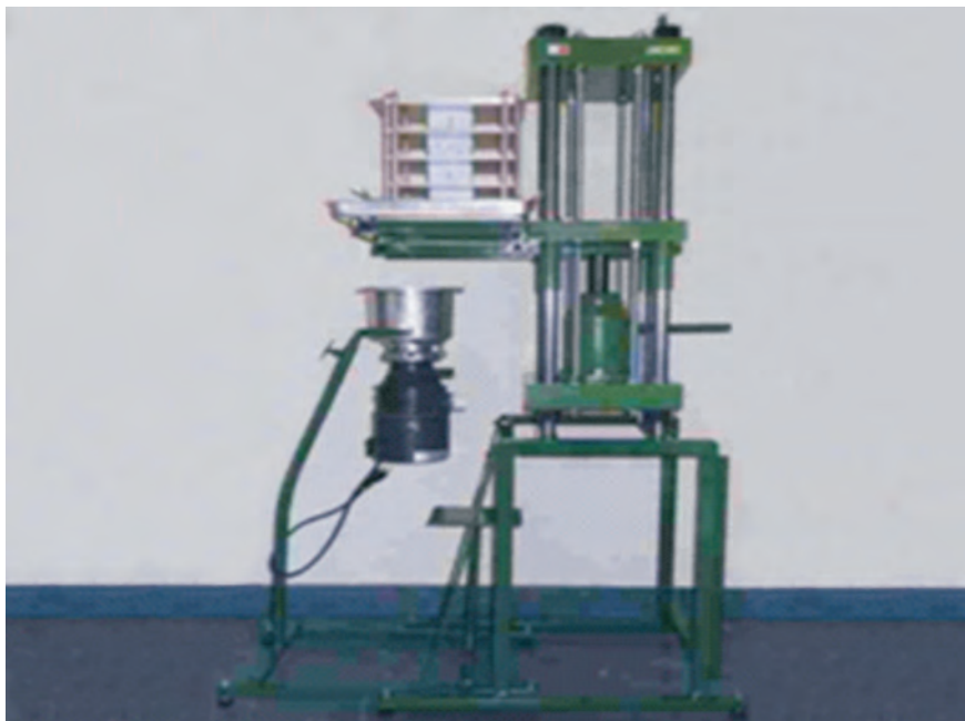
Figura 24 - Extrator de azeite pelo sistema de prensagem hidráulica a frio e decantação por gravidade sem filtragem
