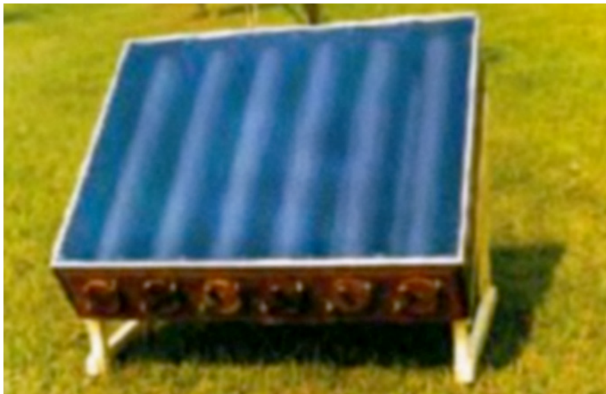
Figura 2 - Coletor solar utilizado para desinfestação de substratos FONTE: Ghini e Bettiol (1991).
