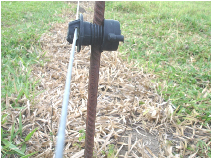
Figura 13 - Modelo de isolador para vergalhão
