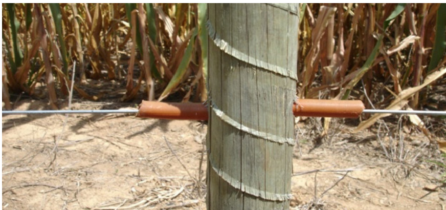
Figura 9 - Isolador tipo mangueira
