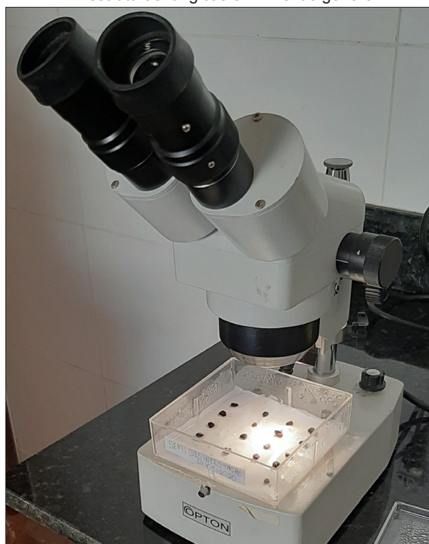
Figura 4 - Avaliação das sementes no microscópio estereoscópico para a identificação morfológica de estruturas fúngicas em nível de gênero
