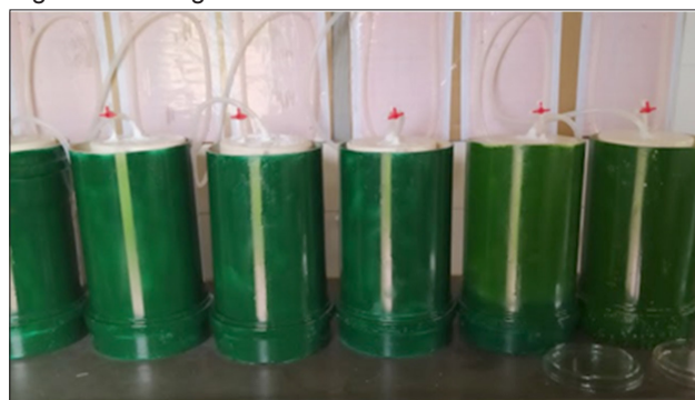
Figura 1 - Biodigestores de bancada
