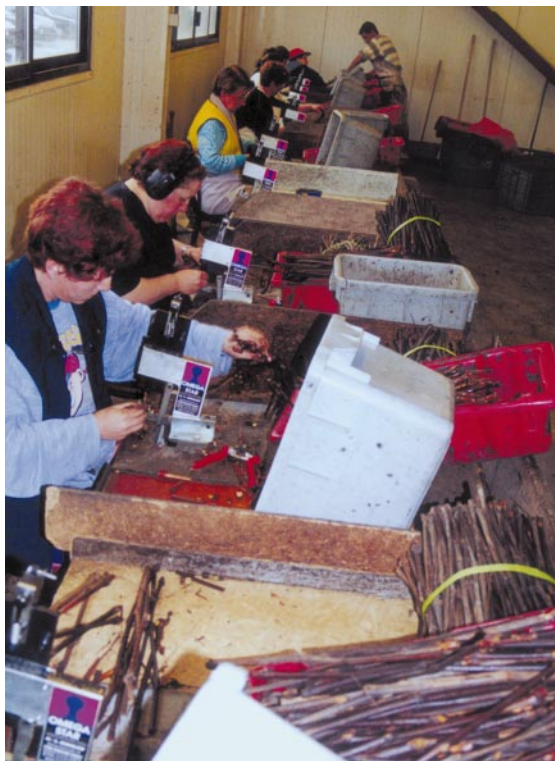
Figura 1 - Enxertia de mesa com máquina tipo Ômega
