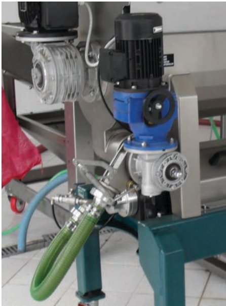
Figura 11 - Bomba de fluxo para injeção de pasta de azeitonas na centrífuga
