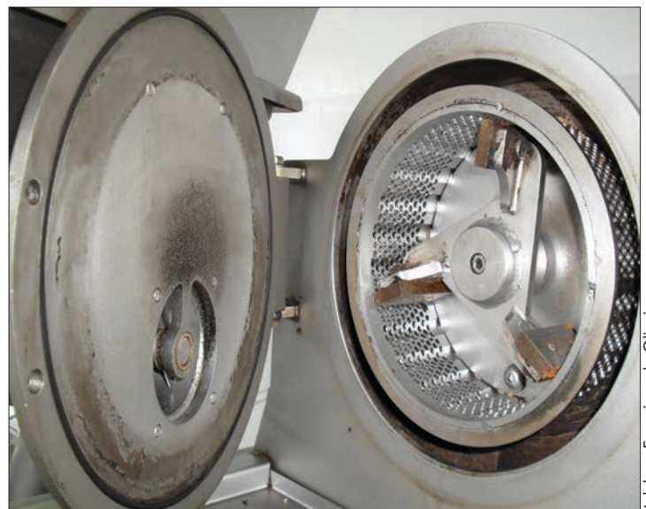
Figura 8 - Moinho em aço inoxidável, estando visível o rotor ou martelos e a peneira
