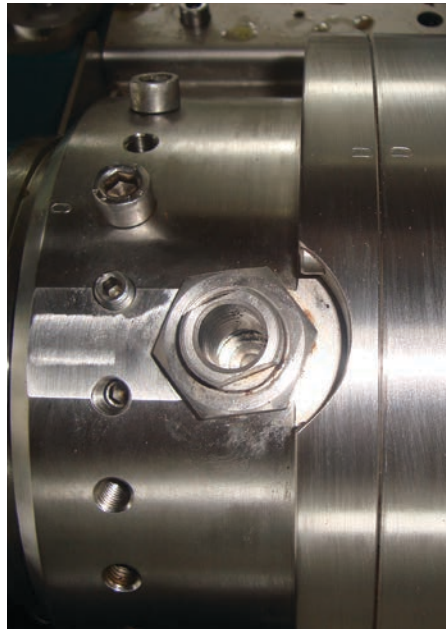
Figura 12 - Bico de saída do azeite de oliva no corpo da centrífuga
