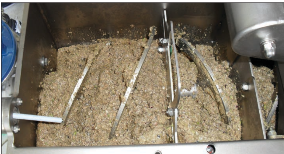
Figura 9 - Batedora horizontal, estando visível as palhetas que auxiliam no revolvimento da pasta
