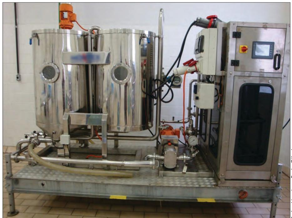
Figura 1 - Protótipo de equipamento UV para tratamento de líquidos turvos, como o leite
