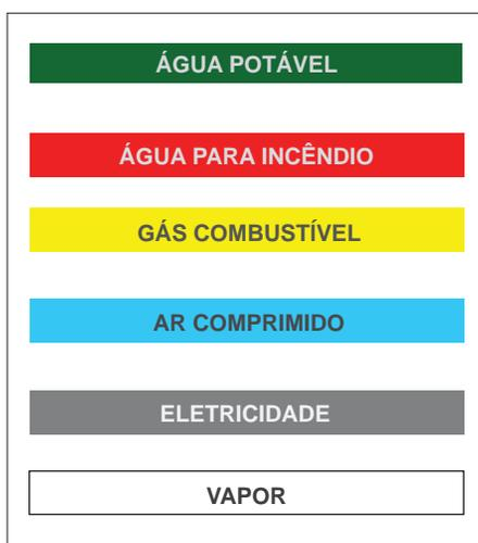
Figura 9 - Cores básicas de pintura aplicada às tubulações em laticínios
