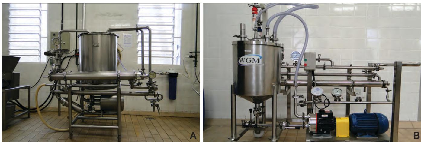
Figura 7 - Equipamento de separação por membrana
