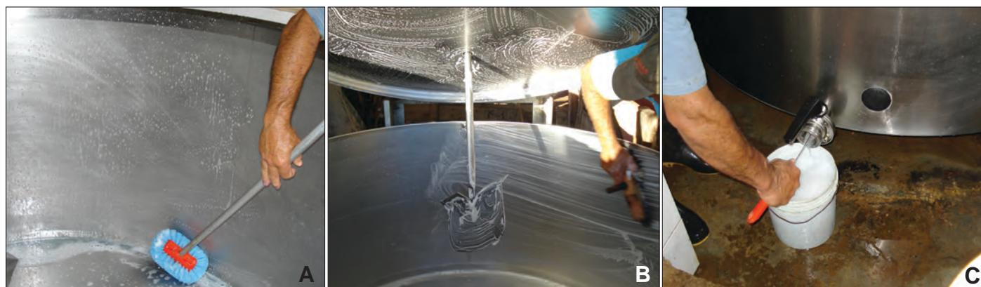
Figura 14 - Procedimento de higienização do tanque de expansão
