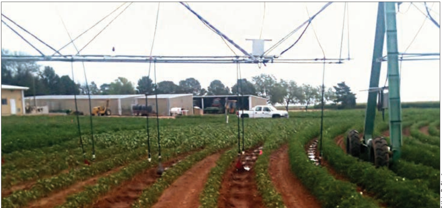
Figura 1 - Sistema de pivô central tipo LEPA
