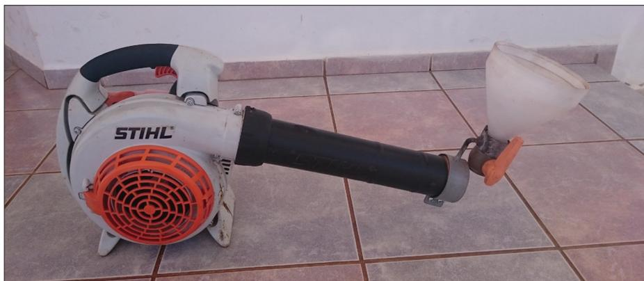
Figura 4 - Soprador de folhas adaptado para a aplicação de isca tóxica na forma de pasta
