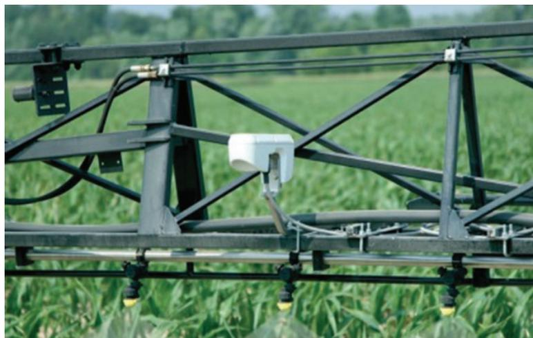
Figura 14 - Funcionamento GreenSeeker
