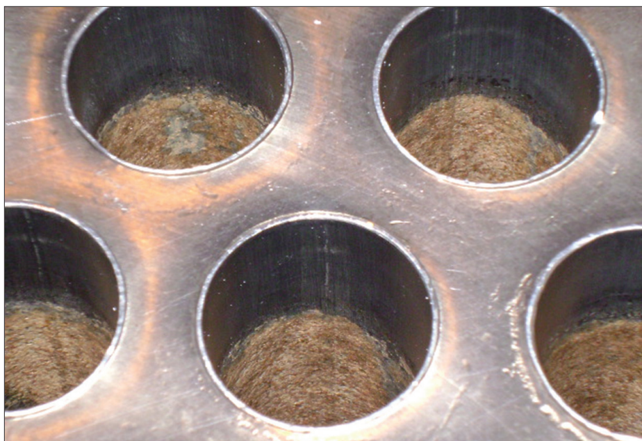
Figura 2 - Tubos de um evaporador com incrustação acastanhada, após 16 horas de processamento de leite em pó
