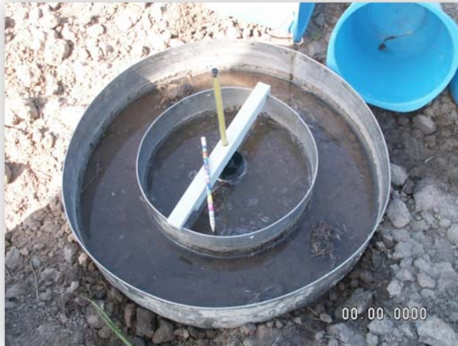
Figura 7 – Infiltrometro de duplo anel. (G.K. Donagemma).
