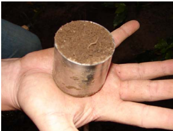
Figura 4 - Anel volumétrico. (Foto de R.B. Prado)
