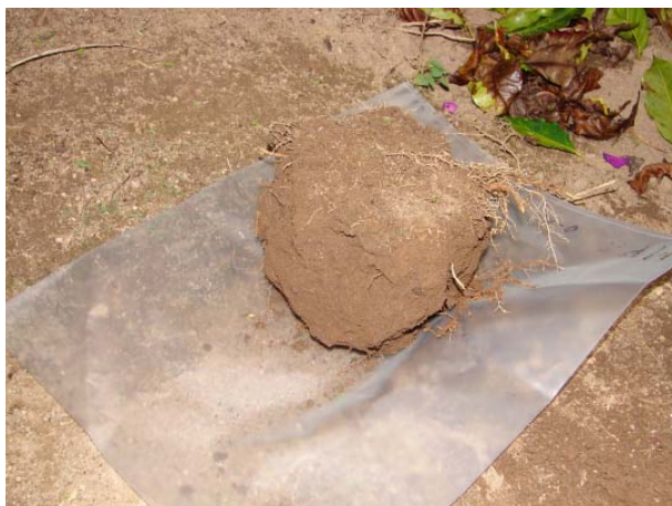
Figura 5 - Bloco para estabilidade de agregados. (Foto de G.K Donagemma)
