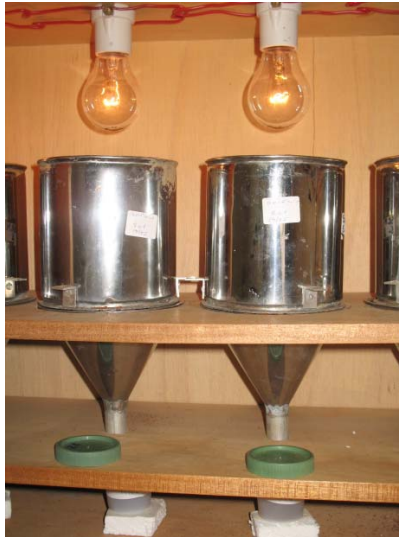
Figura 9 - Extratores do tipo Berlese-Tüllgren, utilizados para extração da mesofauna do solo. (Foto de M.E.F. Correia)
