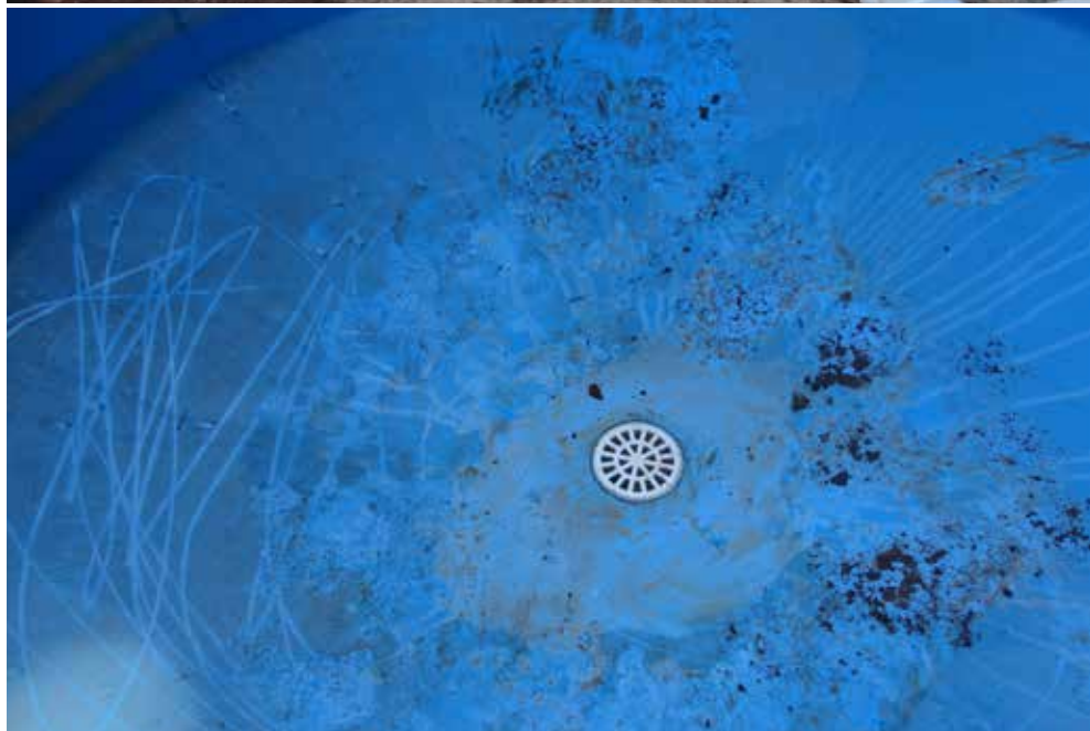
Figura 7 - Caixas de produção com 2.000 litros de capacidade e detalhe do fundo autolimpante, com saída de 100 mm ao centro
