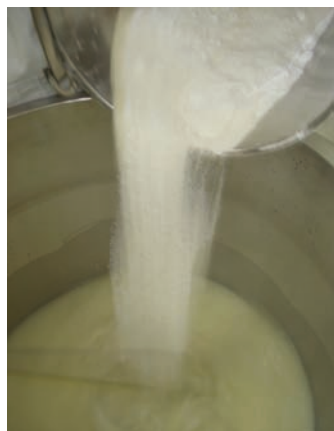
Dissolução e adição dos ingredientes na fermenteira
