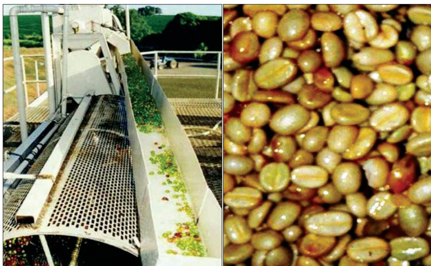
Figura 7 - Máquina de descascar café e café cereja descascado
