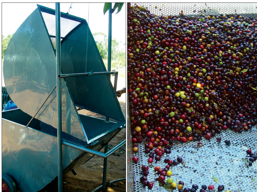
Figura 6 - Modelo de lavador portátil adaptado para a cafeicultura familiar
