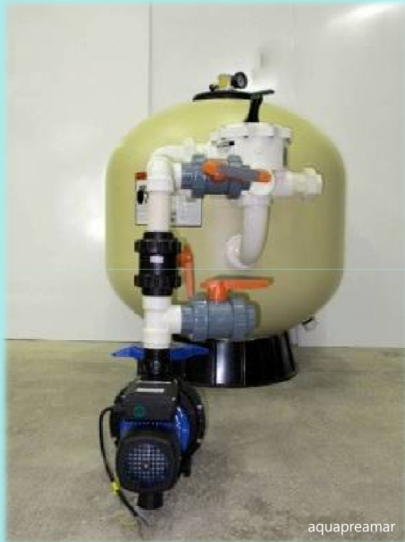
Filtro aeróbio denitrificador
