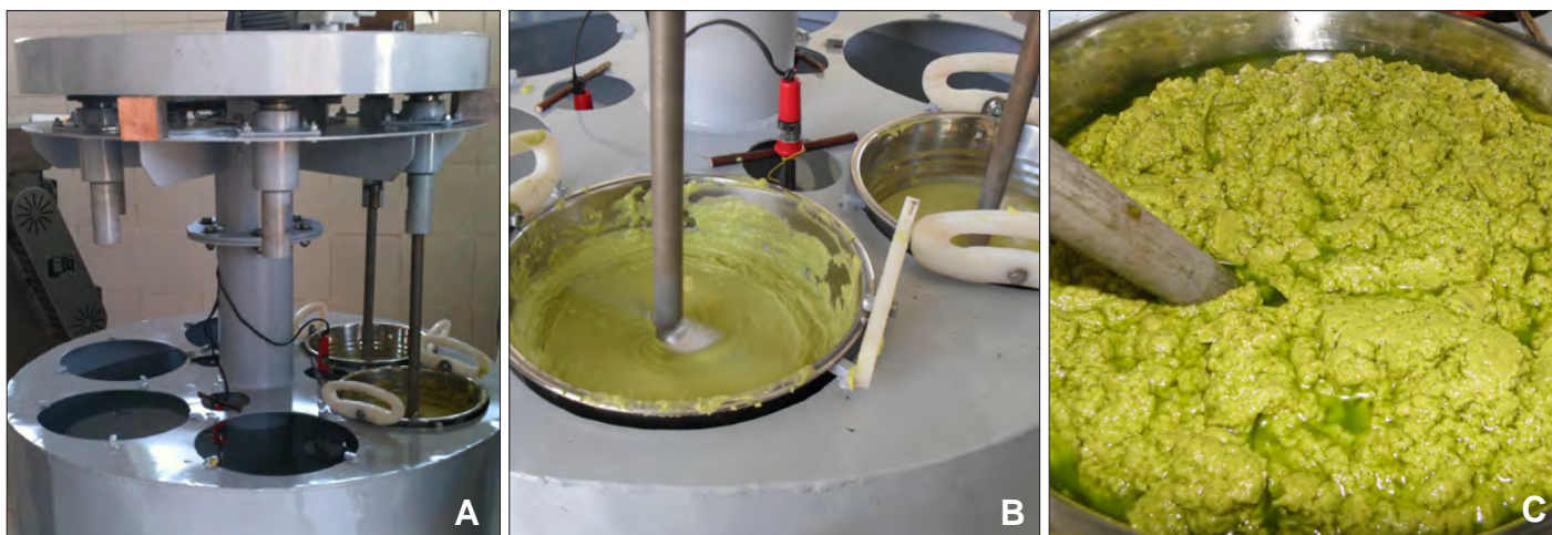
Figura 5 - Batimento da polpa com aquecimento de fundo em banho-maria, tendo como fonte de calor água quente
