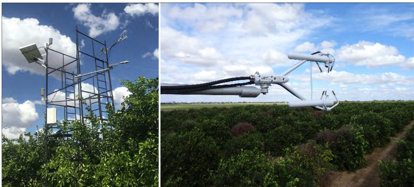
Figura 1 - Sistema de Eddy Covariance (EC) em área de cultivo de lima-ácida Tahiti, no Norte de Minas
