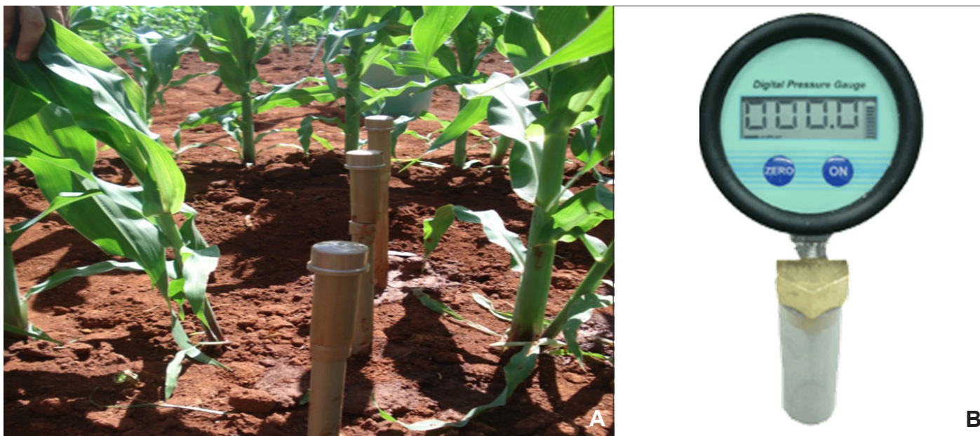
Figura 4 - Equipamentos para o manejo correto da irrigação Nota: A - Tensiômetro; B - Tensímetro (medidor da tensão de água no solo).
