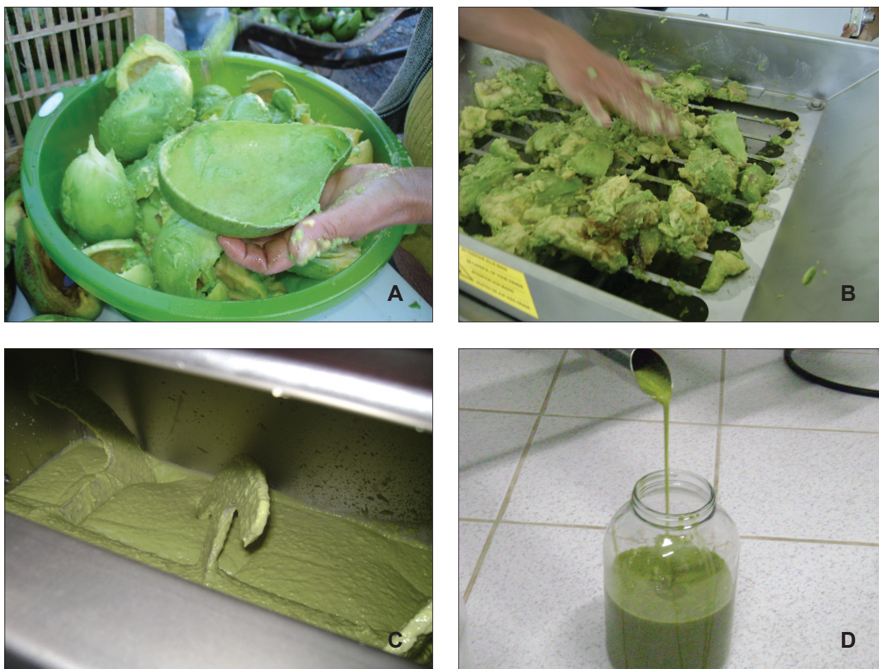
Figura 1 - Extração do óleo de abacate por centrifugação
