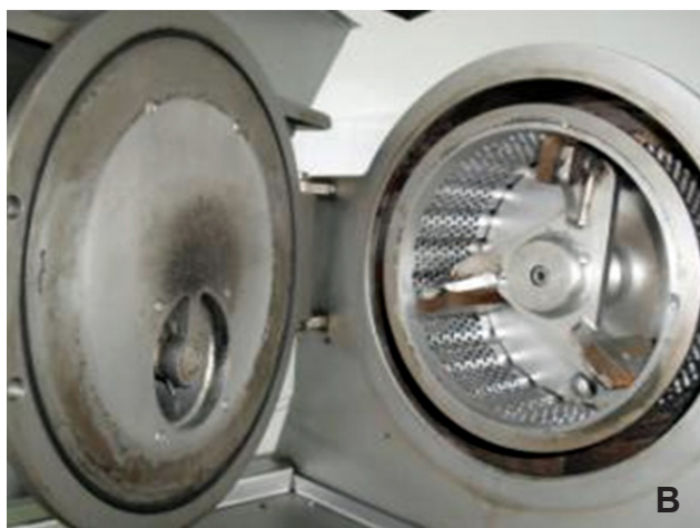
Figura 4 - Batimento da polpa com aquecimento, tendo como fonte de calor água quente
