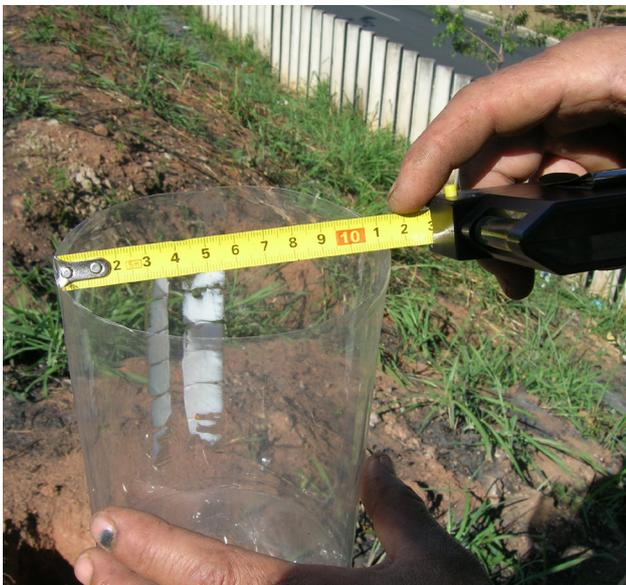
Figura 2 - Diâmetro do coletor de chuva
