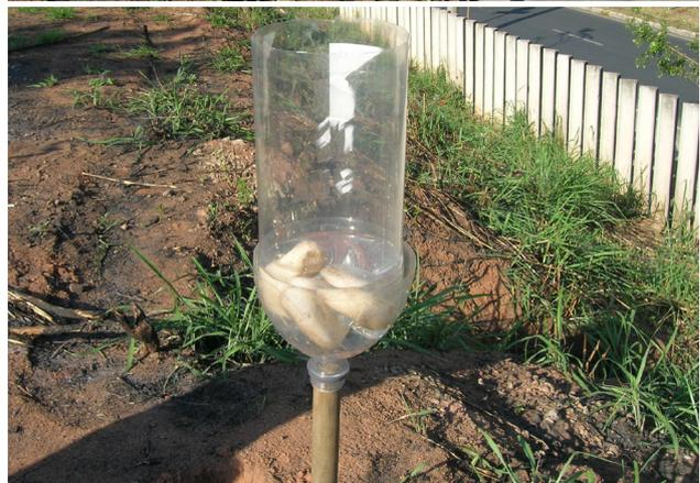
Figura 3 - Instalação do pluviômetro
