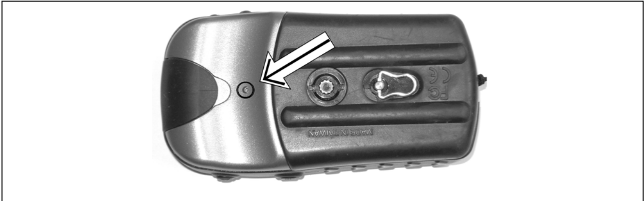
Figura 4 - Orifício de tomada de pressão para determinar a altitude ortométrica
