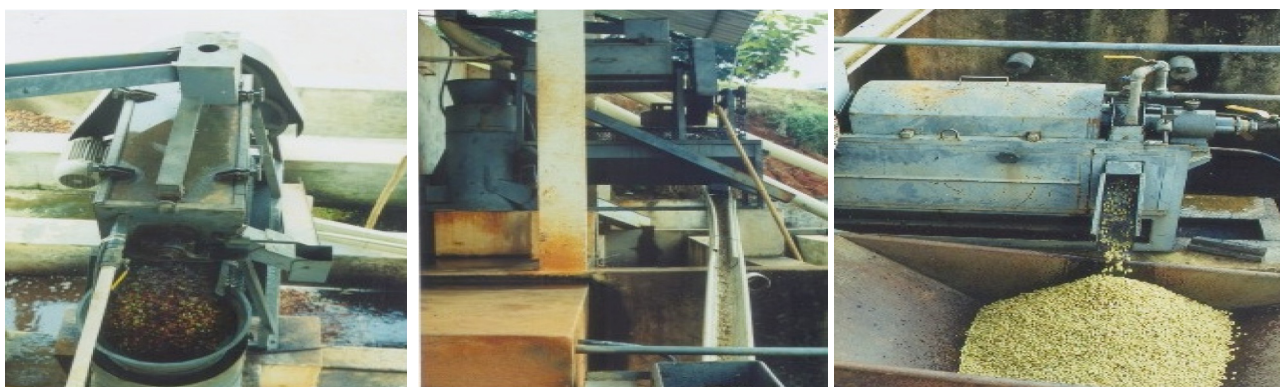
Figura 3 - Descascador de cereja seguido pelo desmucilador
