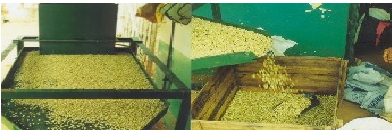
Figura 6 - Máquina classificadora de sementes e separador de mocas
