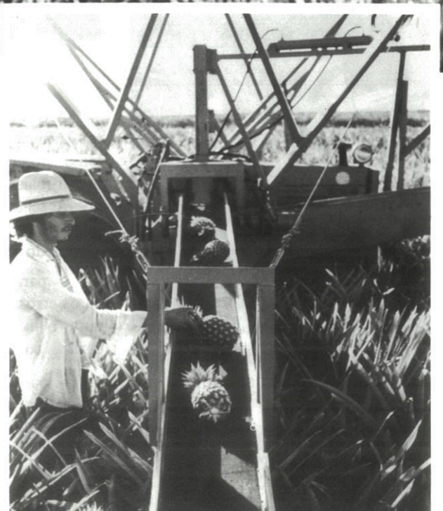
Fotos 10 e 11 – Esteira de colheita fabricada no Brasil. Fazenda Água Limpa – Monte Alto, SP.
