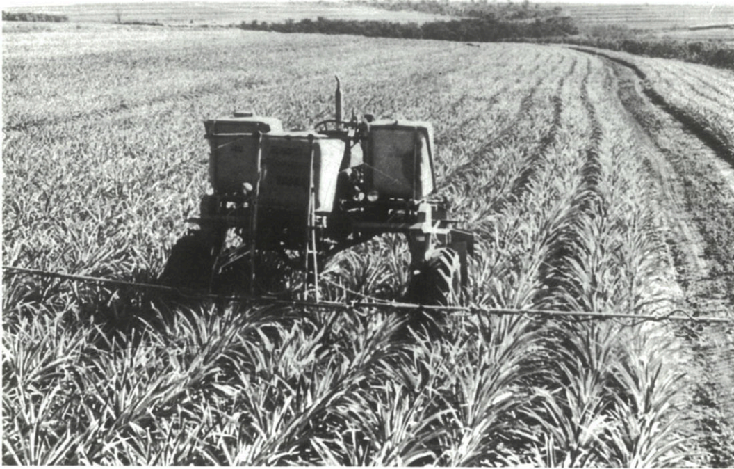
Foto 9 – Trâmpulo equipado com barra aplicadora de defensivos. Em função do pouco comprimento de cada barra, há pouca desuniformidade nas aplicações embora o rendimento seja alto (Larg. total = 9 M). Fazenda Água Limpa – Monte Alto, SP.
