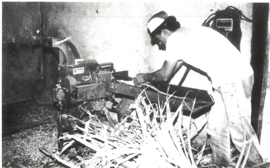
Foto 2 – Picadeira utilizada para triturar restos culturais do abacaxizeiro – Uberaba, 1985.
