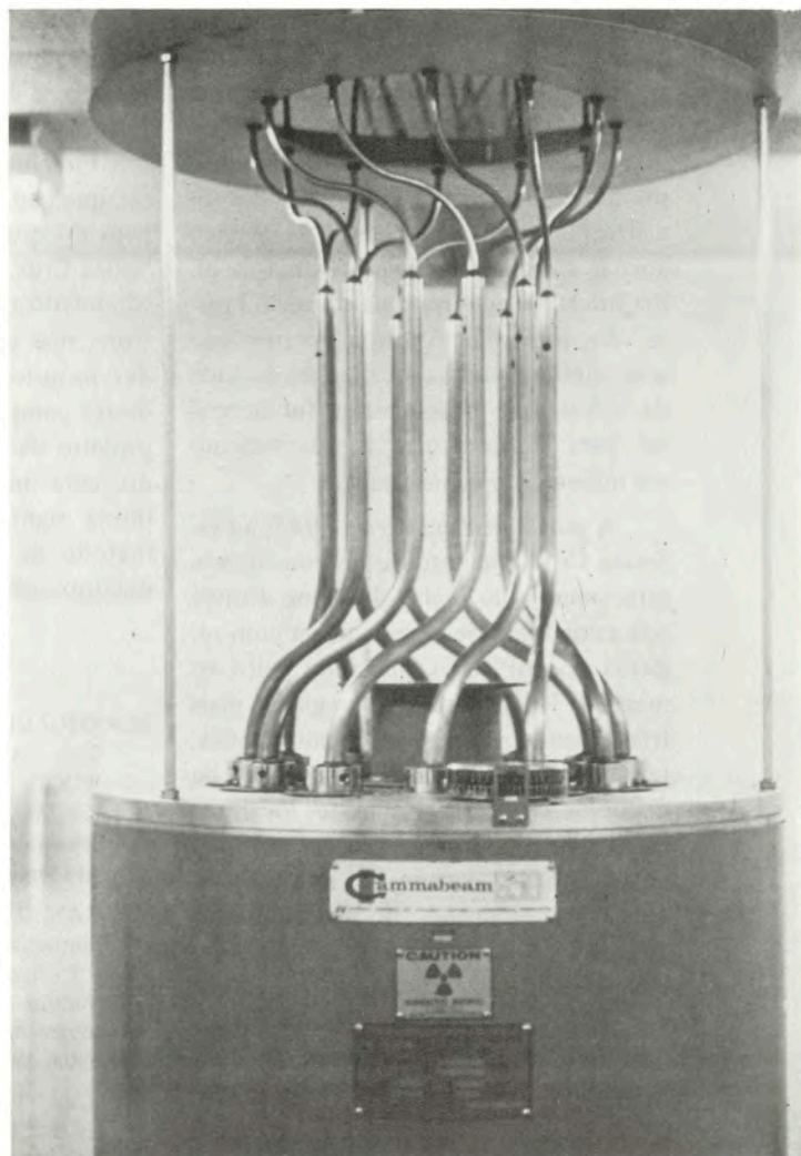
Fig. 1 — Fonte de irradiação gama (cobalto 60) do CENA/USP, que é utilizada para esterilização de insetos.
