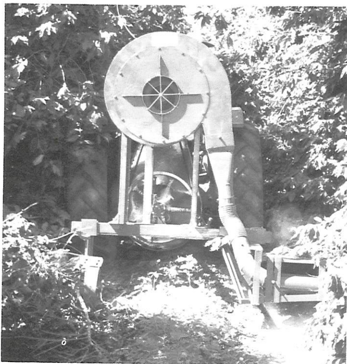
Figura 1 - Arruador pneumático em operação
