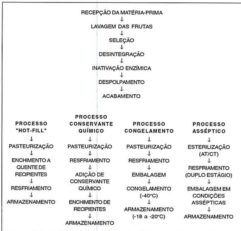
Figura 13 - Fluxograma de processamento da polpa de figo
