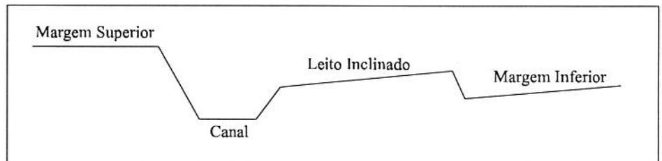
Figura 1 - Estrada com leito inclinado para a margem superior
