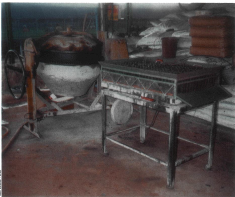
Figura 5 - Betoneira para mistura do osmocote do substrato e umedecimento e mesa vibratória de duas bandejas teladas para enchimento dos tubetes
