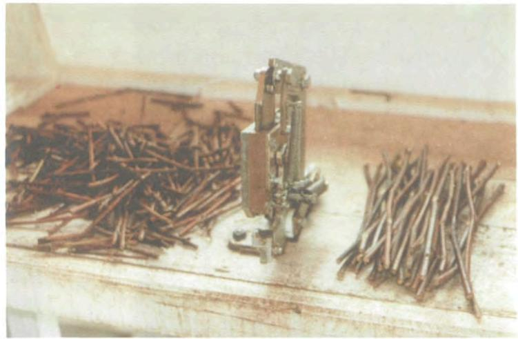
Figura 6 - Máquina de enxertia de mesa tipo ômega
