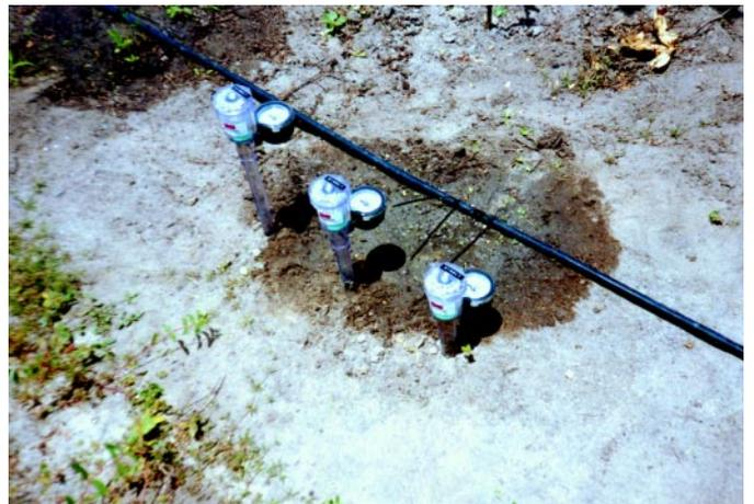
Figura 35 - Tensiômetros instalados em gotejamento de maracujá
