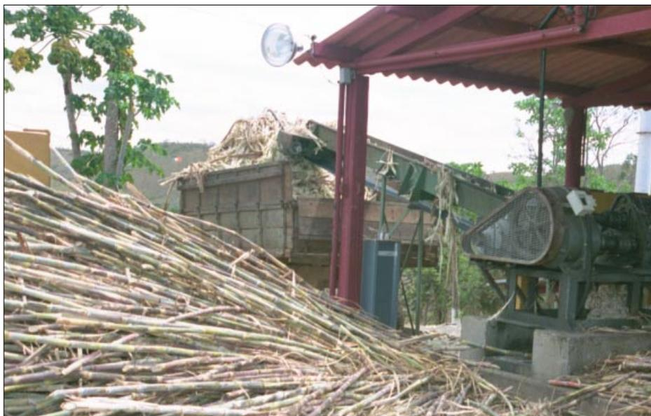
Figura 2 - Processamento (recepção e moagem da cana-de-açúcar) segmento importante da cadeia produtiva da cachaça
