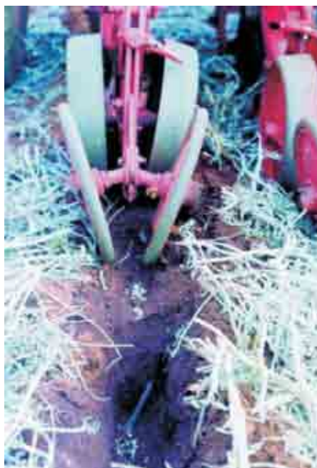
Figura 3 - Semeadora de plantio direto equipada com haste escarificadora
