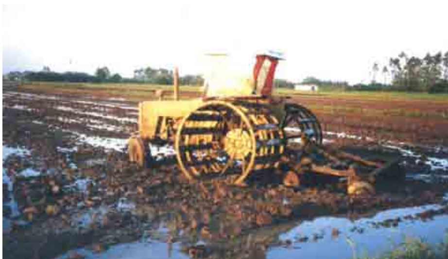
Figura 5 - Detalhe da roda gaiola
