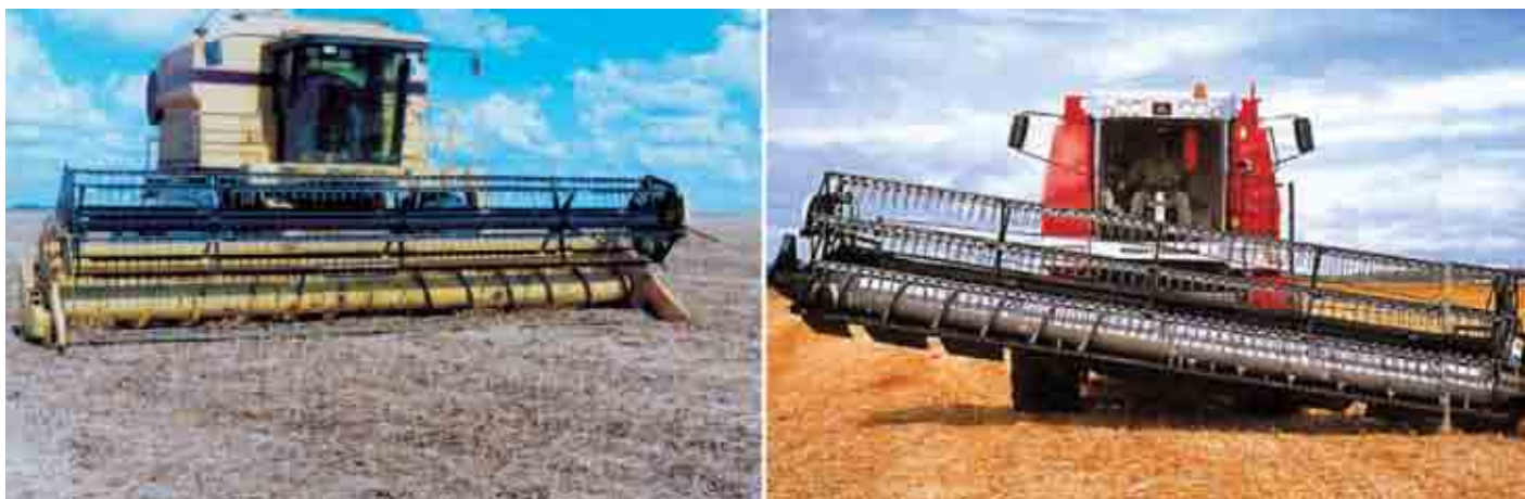
Figura 5 - Plataformas de corte flexível e com ajuste transversal
