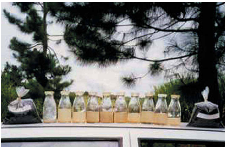
Figura 3 - Amostras coletadas pelo método de incremento de larguras iguais
