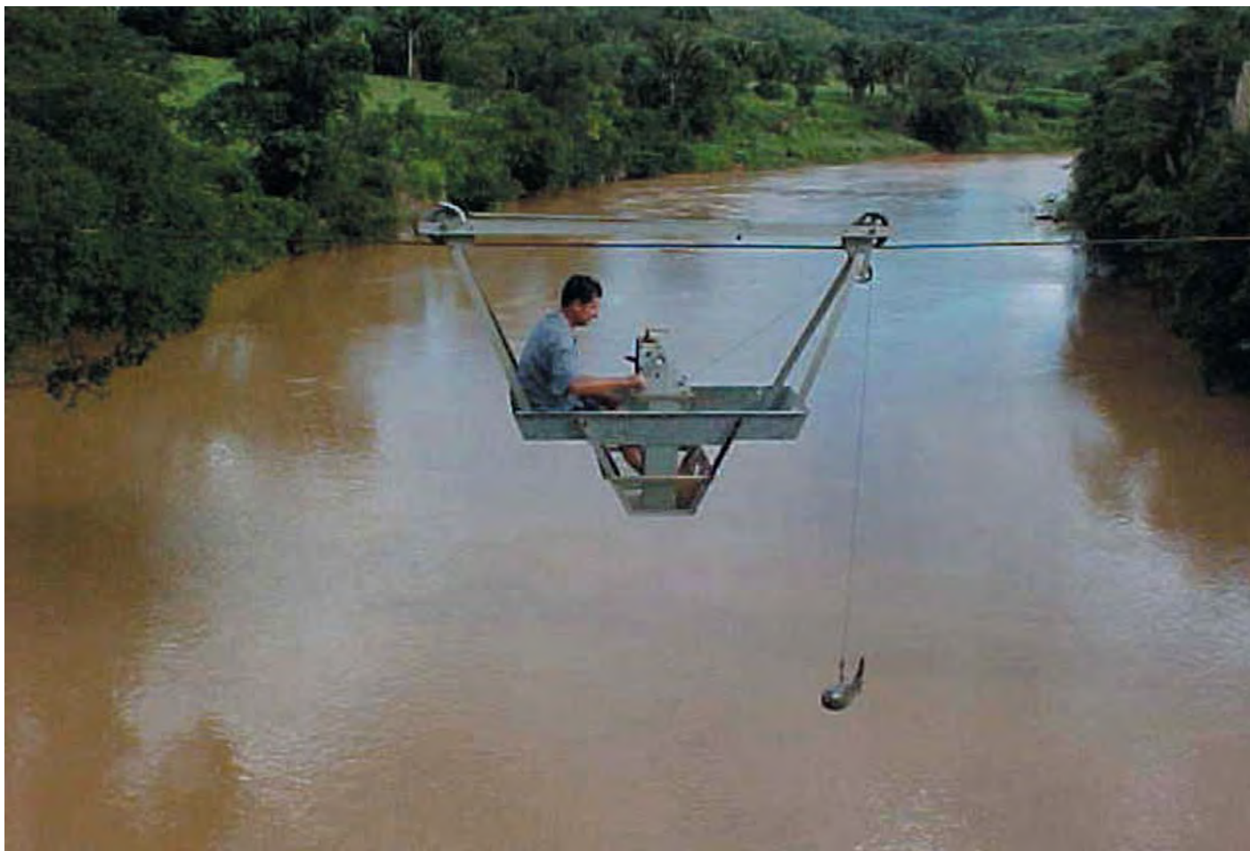
Figura 1 - Coleta pelo método de incremento de descargas iguais
