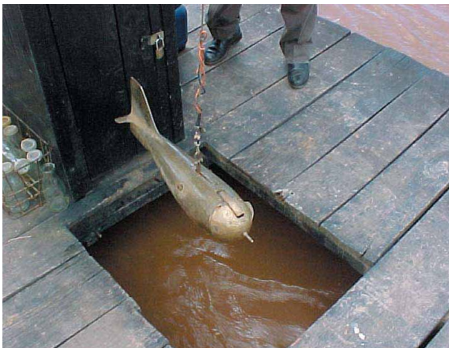
Figura 2 - Coleta pelo método de incremento de larguras iguais
