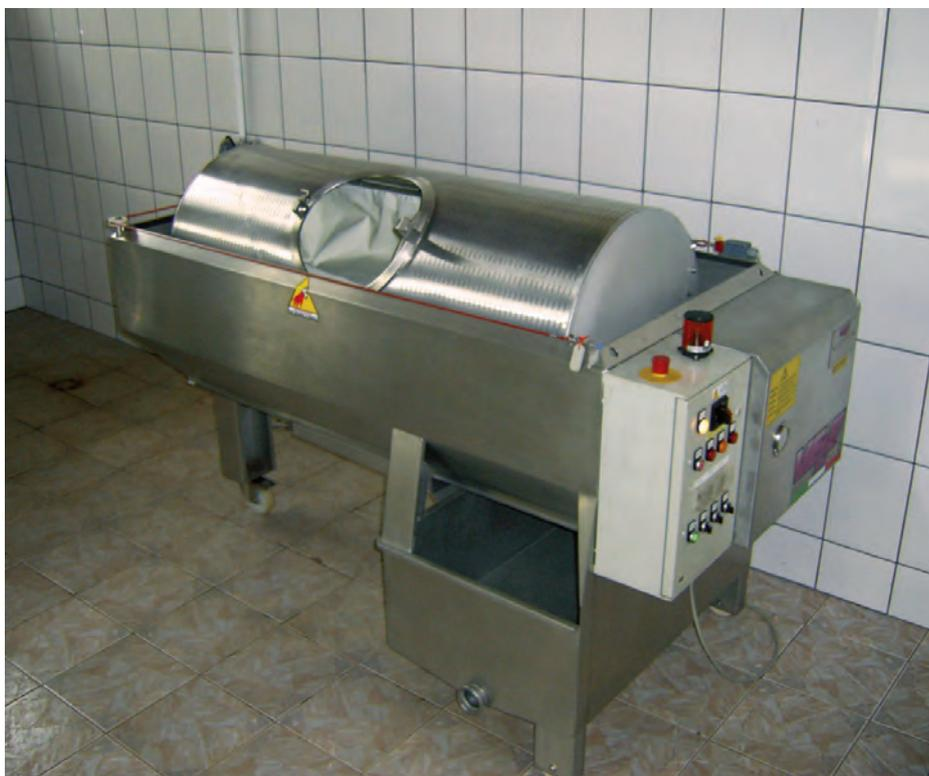
Figura 5 - Prensa pneumática
