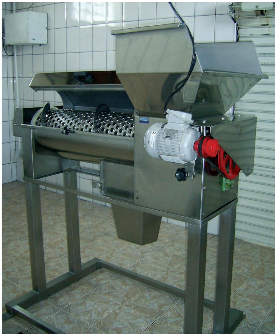
Figura 2 - Desengaçadeira com controle de velocidade
