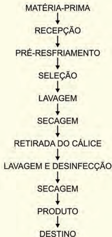
Figura 1 - Fluxograma das etapas necessárias para o processamento do morango
