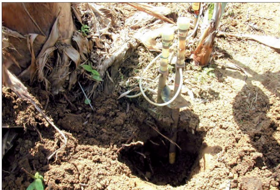
Figura 5 - Posicionamento de tensiômetros na cultura da bananeira irrigada por microaspersão
