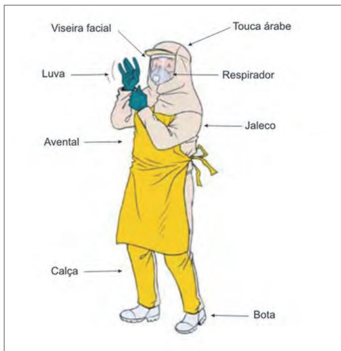
Figura 1 - Equipamentos de Proteção Individual (EPIs)
