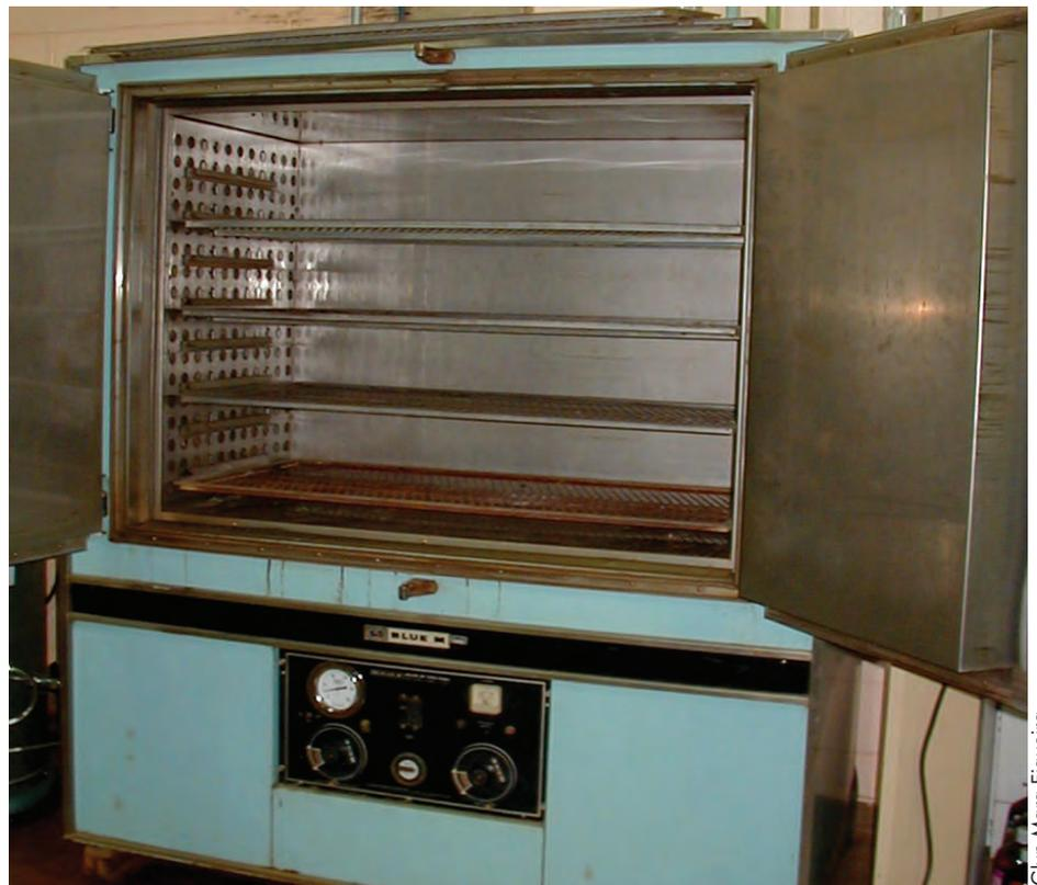
Figura 1 - Estufa com circulação forçada de ar
