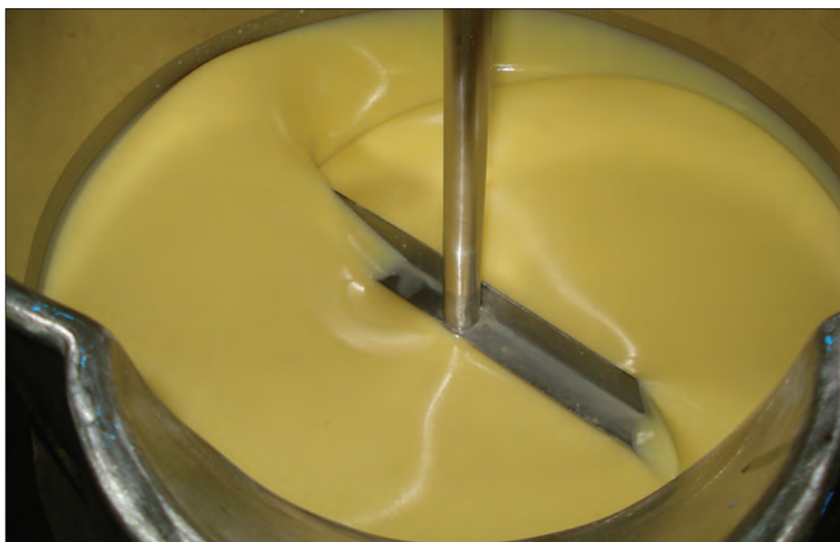
Figura 5 - Processo de cristalização do leite condensado em tanque - EPAMIG-Instituto de Laticínios Cândido Tostes (ILCT)
