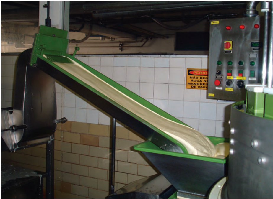
Figura 5 - Sistema de filagem mecânica de mussarela
