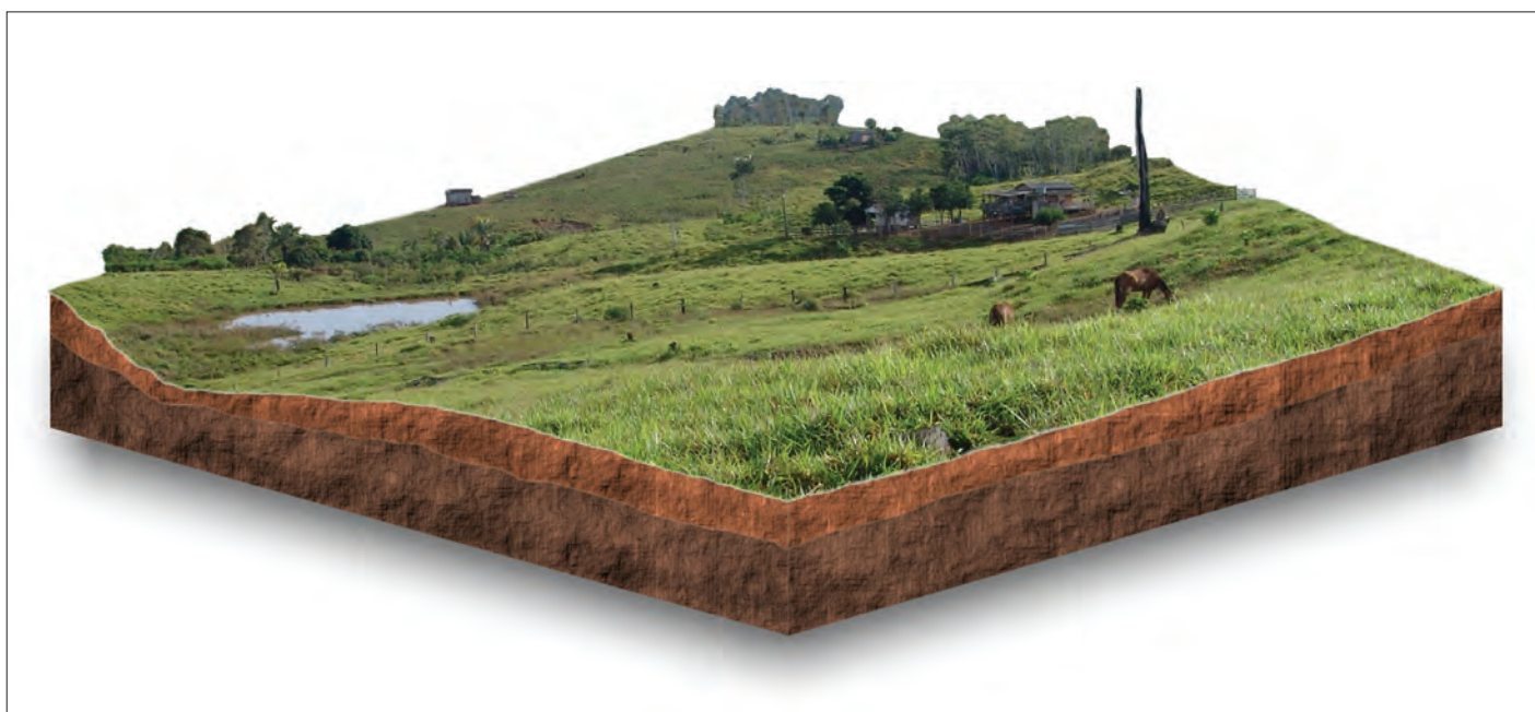
Figura 3 - Modelo Digital de Elevação (MDE) com sobreposição de um mosaico de aerofotos verticais de parte de uma propriedade rural
