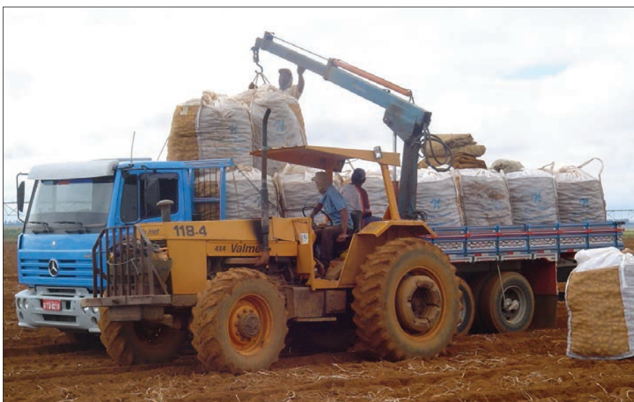
Figura 18 - Recolhimento dos big-bags na lavoura, com auxílio de guincho acoplado ao trator - município de Araxá, MG
