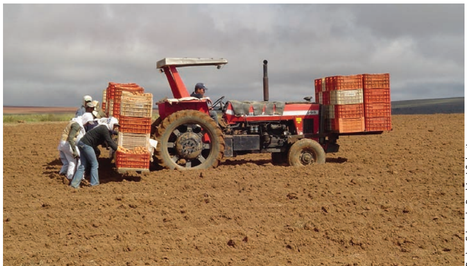
Figura 2 - Plantio semimecanizado utilizando trator com suporte para caixas de batata-semente para 6 sulcos e distribuição manual dos tubérculos - Chapada Diamantina, Bahia
