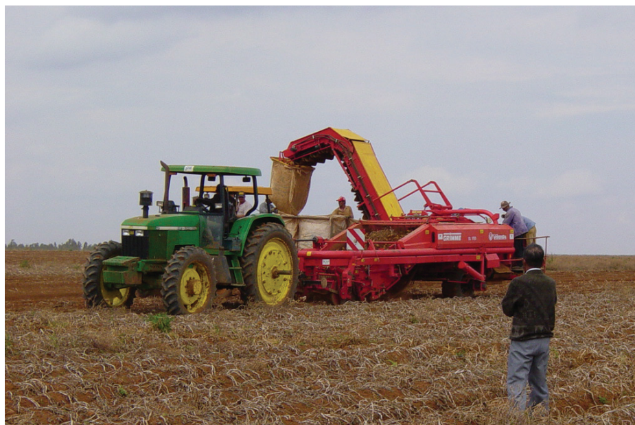
Figura 16 - Colheita mecanizada com a colheitadeira acoplada ao trator que efetua a colheita e descarrega em bags dentro da carreta acoplada a outro trator que locomove paralelamente à colheitadeira - Chapada Diamantina, Bahia
