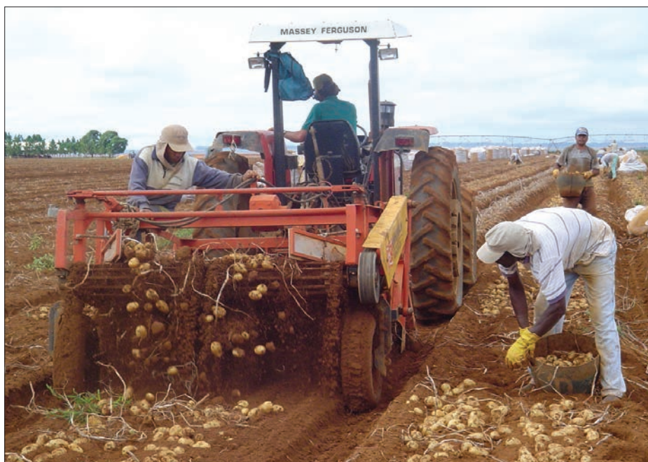
Figura 15 - Colheita semimecanizada, utilizando uma esteira acoplada ao trator para arranque dos tubérculos, e a catação é feita manualmente - São Gotardo, MG
