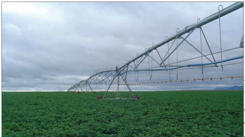
Figura 7 - Irrigação por pivô central com barra de pulverização acoplada - Chapada Diamantina, Bahia
