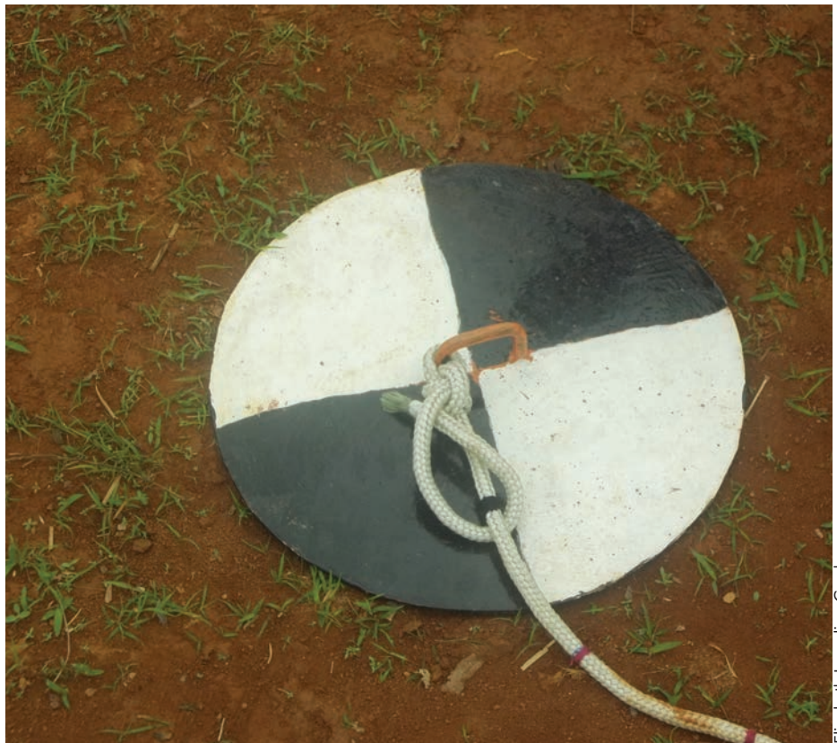
Figura 1 - Disco de Secchi para avaliação da transparência da água
