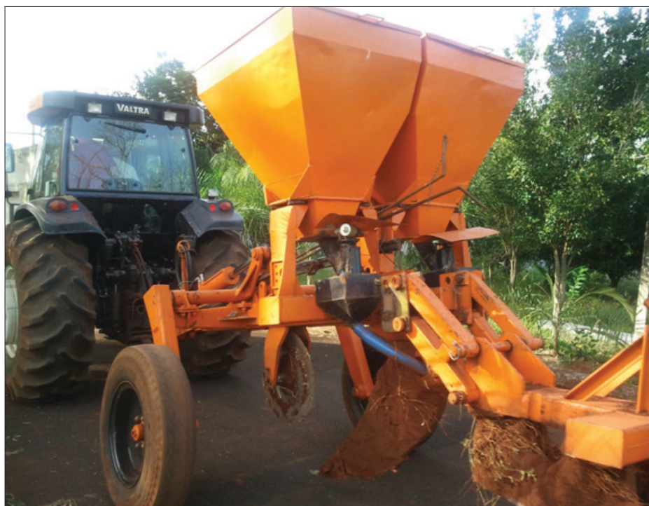
Figura 3 - Subsolador florestal indicado para descompactação e fosfatagem nos sulcos de plantio das mudas
