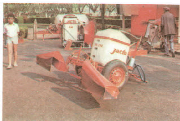
Fig. 68 - Aplicador de herbicida PH-200 com as suas asas laterais protetoras que passa na linha sob os cafeeiros.
