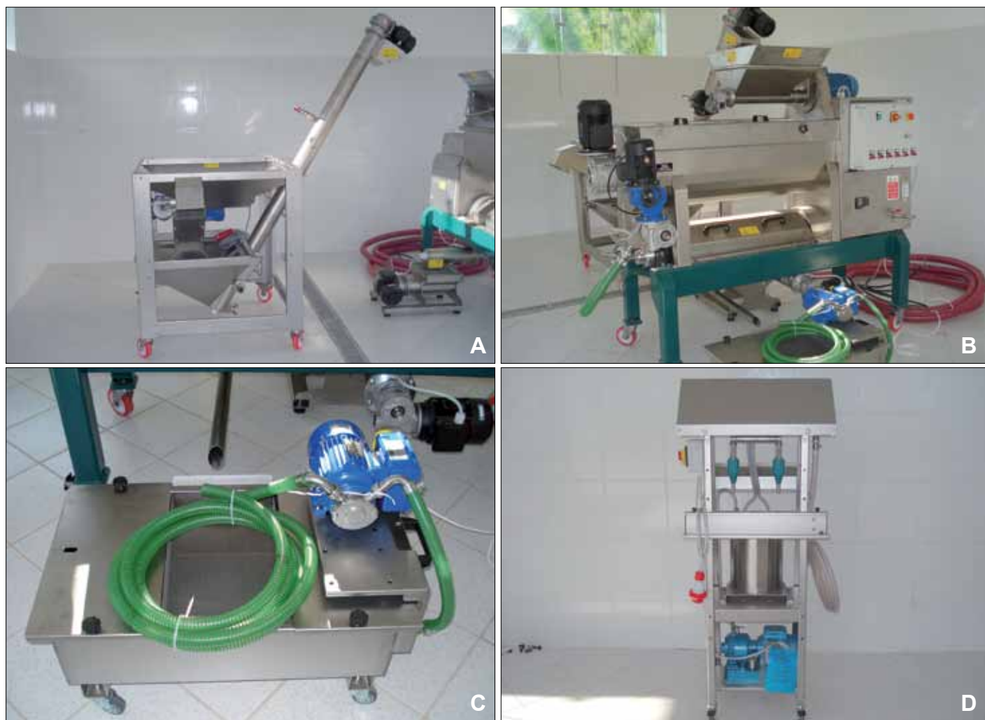
Figura 5 - Lagar - unidade para extração de azeite de oliva
